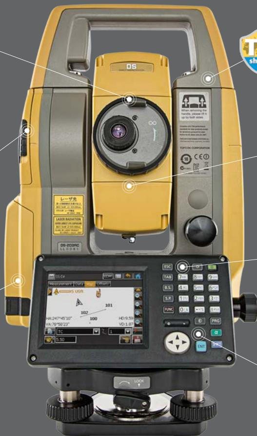
Rango de EDM rápido y potente, de hasta 1000 m sin prisma
